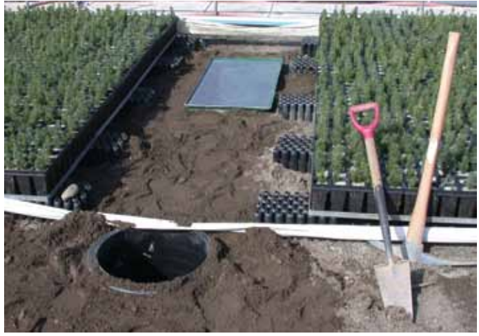
Figure 1. Capteur de lessivat avec puits de récupération sous une culture d'épinette blanche 2+0 en récipients.
