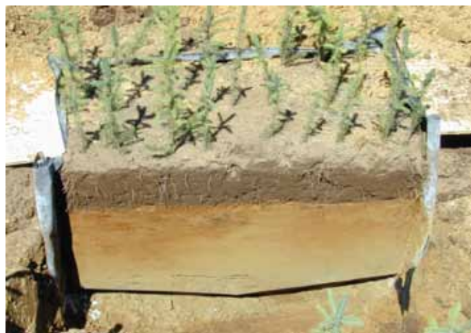
Figure 3. Case lysimétrique composée d'un monolithe reposant sur une plaque en acier inoxydable, sous une culture d'épinette blanche à racines nues.
